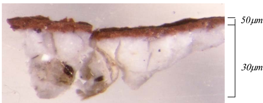
Figure 165 : coupe stratigraphique d'un prélèvement rouge, PGm 09 (MOLR x40).
