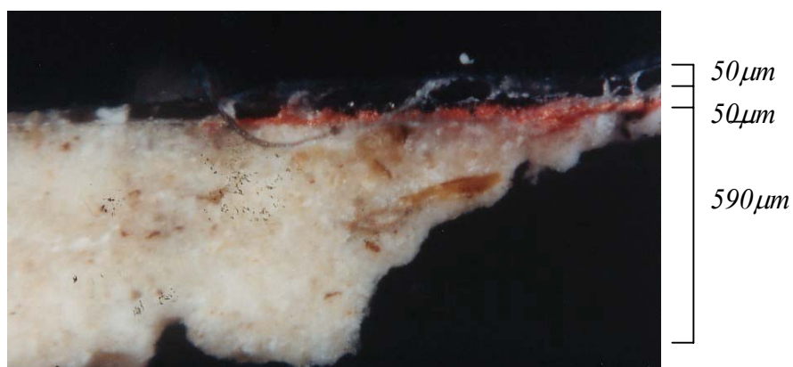
Figure 144 : coupe stratigraphique de l'échantillon rouge PGm 07 (MOLR x100).
