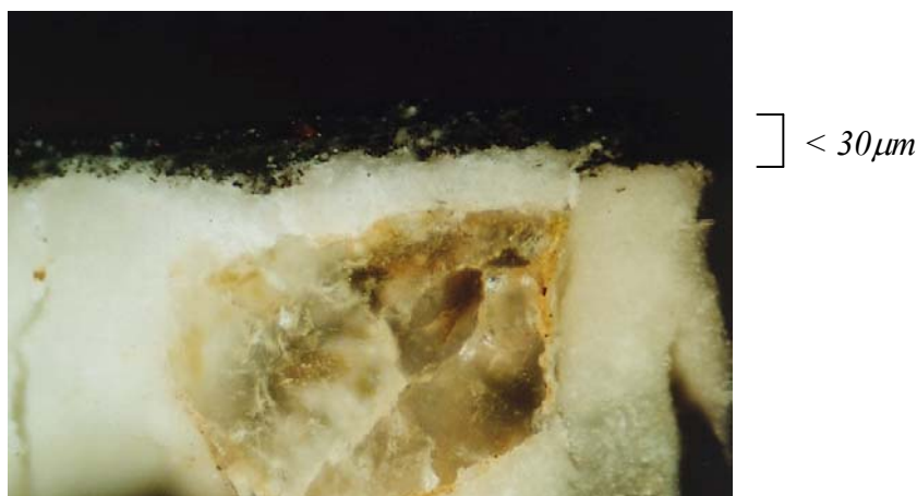
Figure 158 : coupe stratigraphie du prélèvement noir PGm 08 (MOLR x160).
