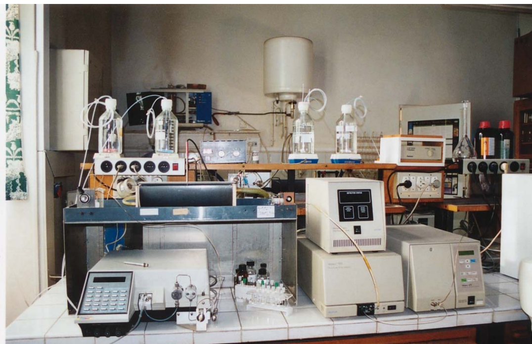
Figure 59 : instrumentation pour la chromatographie liquide à haute performance avec double détection.
