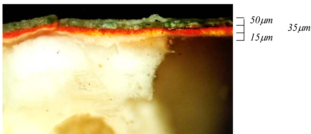
Figure 160 : coupe stratigraphie du prélèvement vert (MOLR x160).
