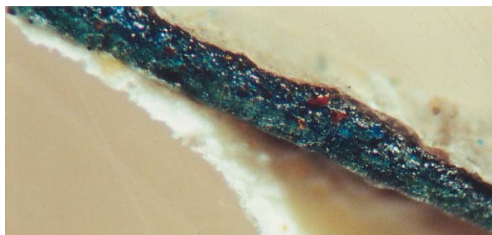
Figure 231 : coupe stratigraphique du deuxième prélèvement de bleu (MOLR x40).
