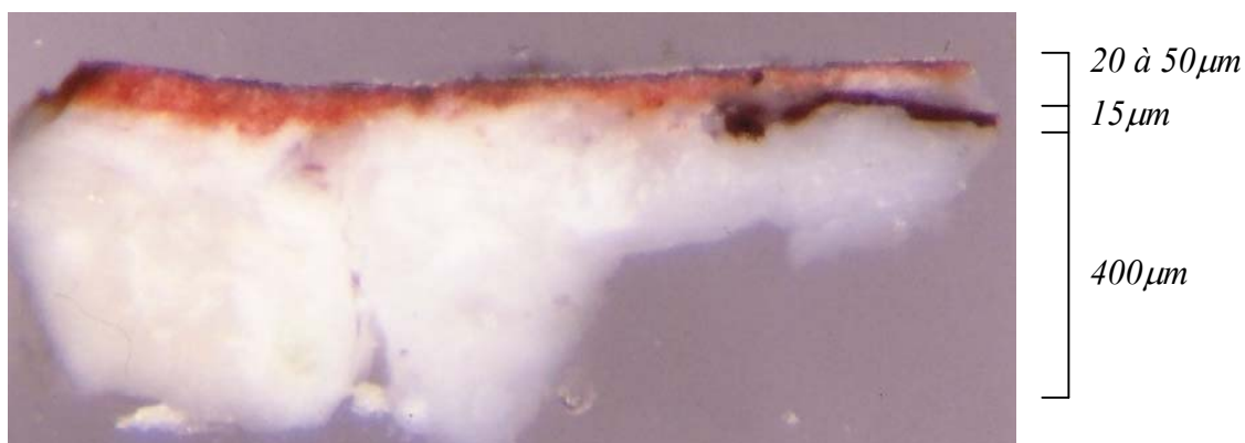
Figure 174 : coupe stratigraphique d'un prélèvement rouge, PGm 16 (MOLR x40).
