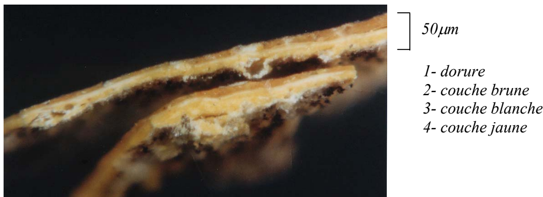
Figure 149: coupe stratigraphique de la dorure de l'auréole du saint (MOLR x100).
