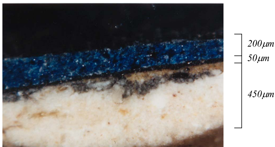
Figure 140 : coupe stratigraphique du prélèvement bleu (MOLR x100).
