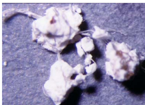
Figure 154 : prélèvements de l'enduit présentant des fibres (MOLR).
