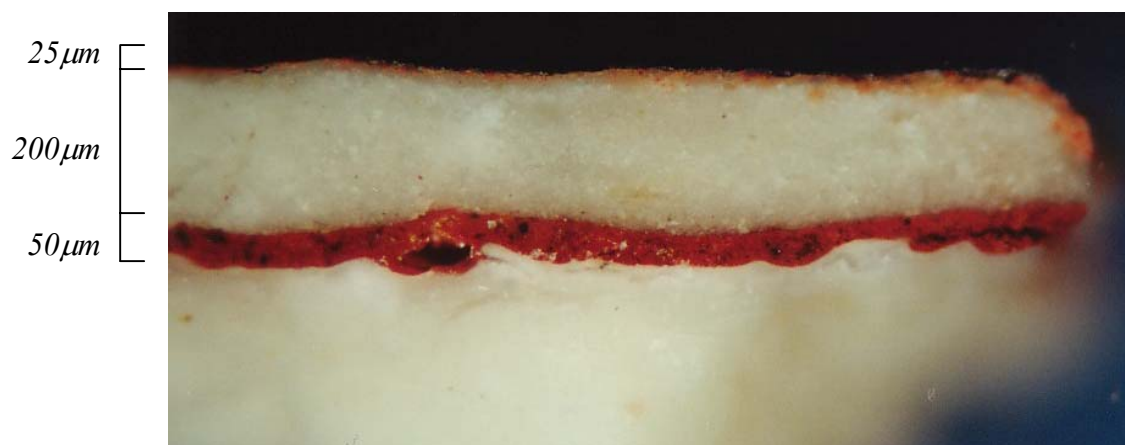
Figure 166 : coupe stratigraphique d'un prélèvement rouge, PGm 11 (MOLR x80).
