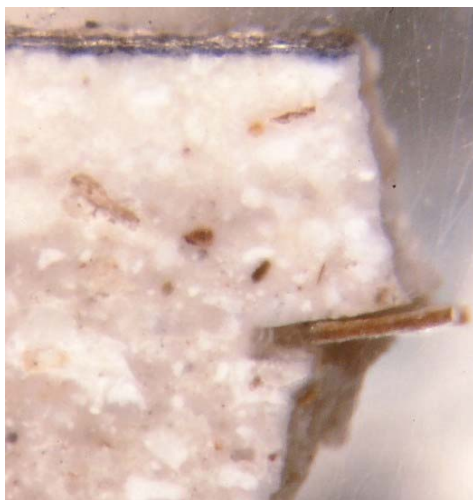
Figure 157 : coupe stratigraphique du prélèvement gris (MOLR x40).
