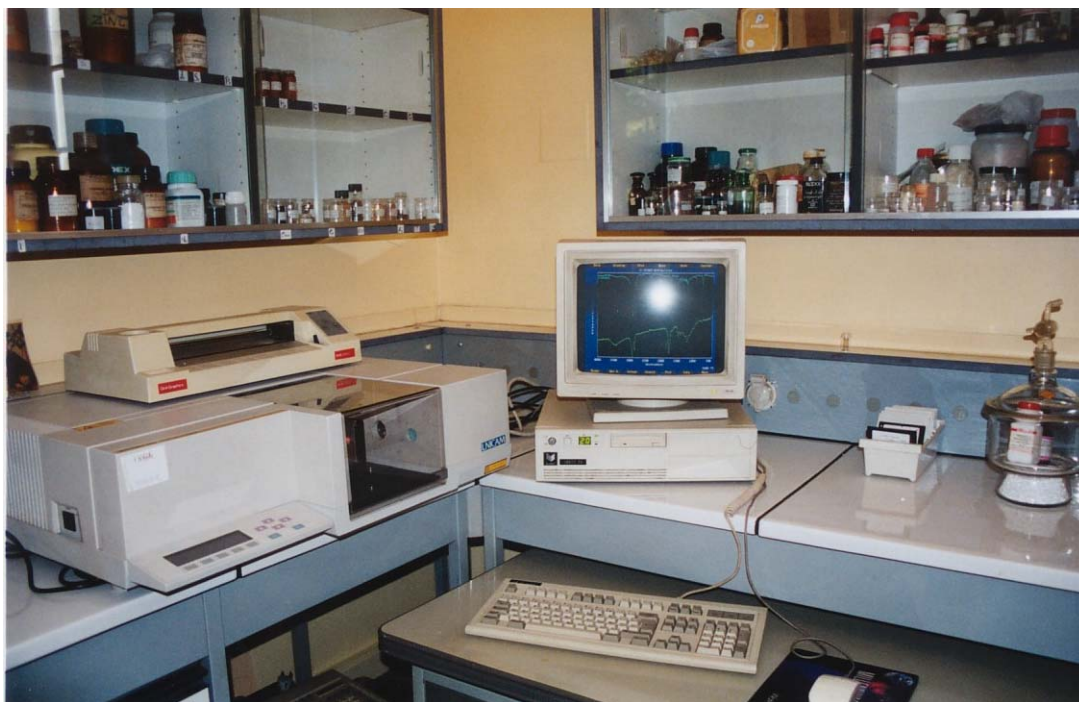
Figure 252 : instrumentation pour la spectroscopie IRTF.
